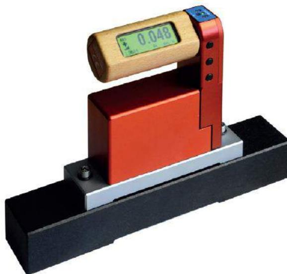
Дополнительное гранитное основание для крепления на уровень. Расстояние между крепежными отверстиями М6, 130 мм
